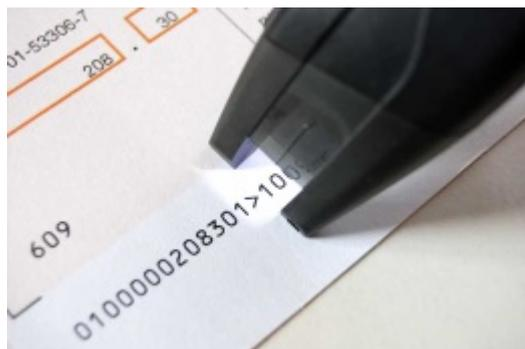
Diese Belegleser werden in der Regel via USB-Schnittstelle mit dem Computer verbunden und simulieren die Eingabe per Tastatur. Man braucht nur die Codierzeile einzulesen, damit die Software aufgrund der gefundenen Informationen eine Zahlung für den entsprechenden Kreditor vorbereitet.
